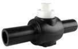
PE BALL VALVE (REDUCED BORE) PE KÜRESEL VANA (REDÜKSİYON GEÇİŞ) SDR11 PE100 GAS/GAZ : 10 BAR WATER/SU : 16 BAR
