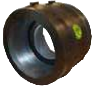
EF DUST COUPLER EF DOST MANŞON SDR 11 PE100 GAS / GAZ : 10 BAR WATER / SU : 16 BAR
